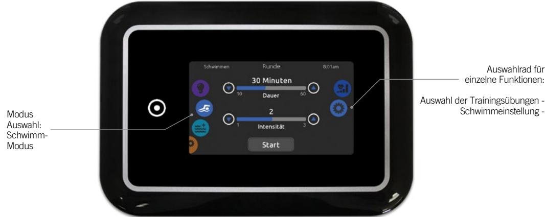
Die Dauer aller Trainingsübungen und die Intensität aller Übungen sind auf dieser Seite eingestellt. Die Anzahl der verfügbaren Intensitäten hängen von der Konfiguration des Swim-Spa und von der ausgewählten Trainingsübung ab, deren Name oben auf dem Bildschirm angezeigt wird.
